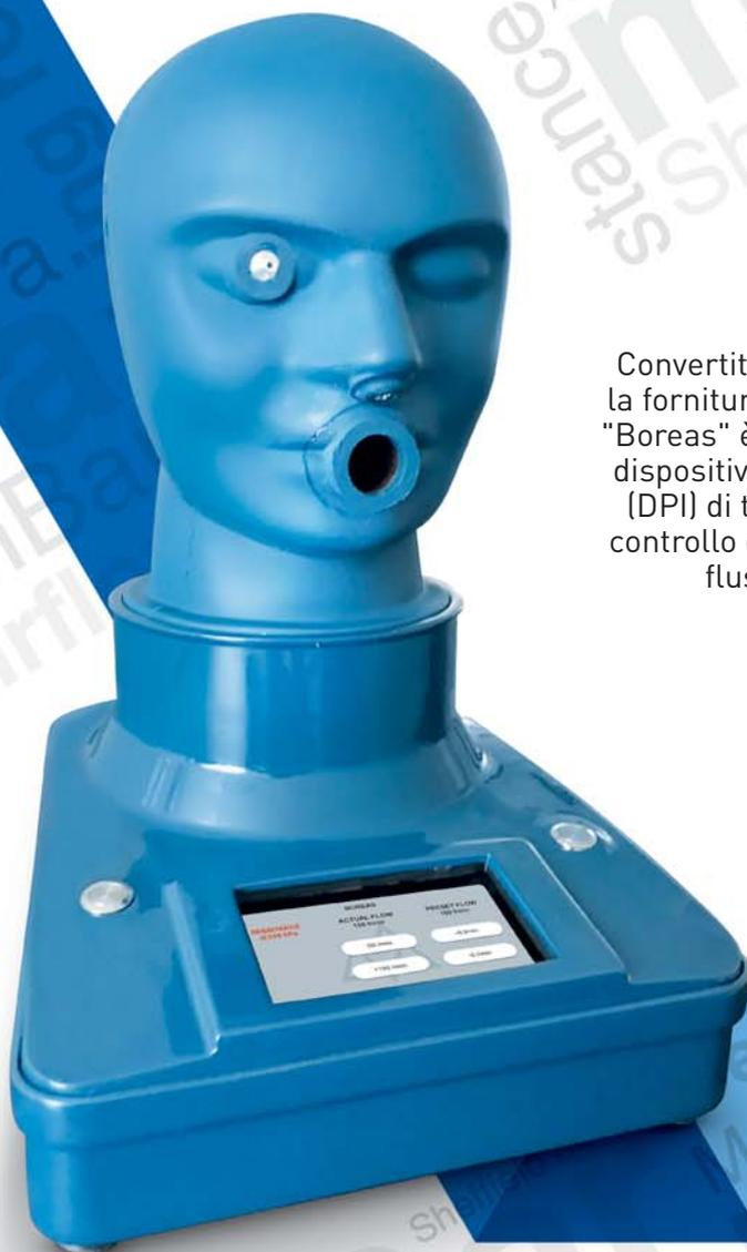
Convertitore di portata del gas per la fornitura di flusso d'aria costante "Boreas" è progettato per le prove di dispositivi di protezione individuale (DPI) di tipo filtrante in termini di controllo della resistenza iniziale al flusso d'aria costante.
