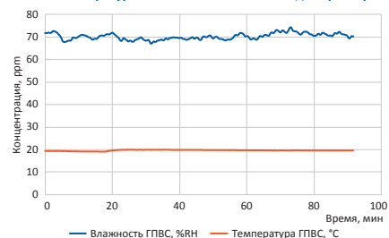
Испытания на стенде Динамика Протокол №9 от 28.03.2020 Температура и влажность ГПВС на входе в фильтр
