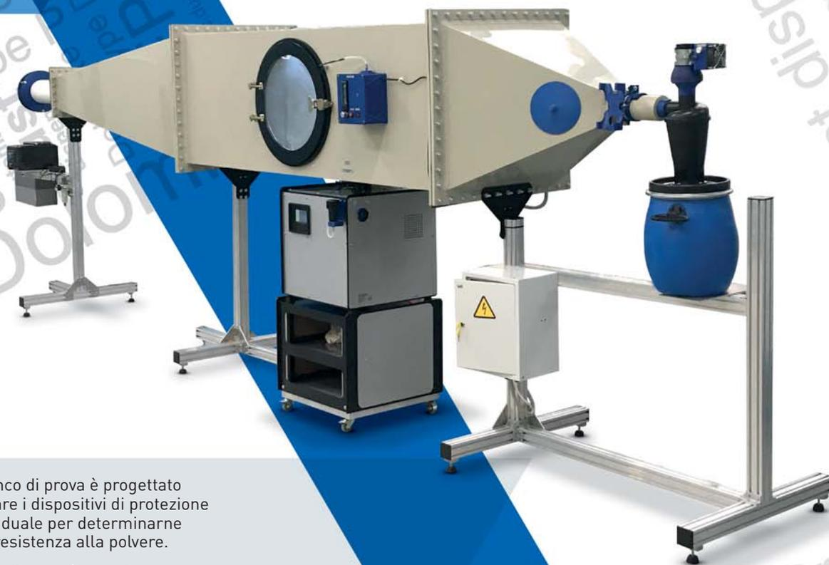
Il banco di prova è progettato per testare i dispositivi di protezione individuale per determinarne la resistenza alla polvere.
